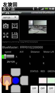
右モーターのみ正回転し、左前方に旋回する
